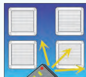
Jednotlivé ventilátory nebo skupiny ventilátorů mohou být ovládané pomocí dálkového ovládače TRM3.
