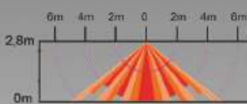
Umístění čidla na strop
